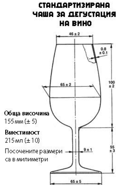
Slika: standardna čaša za degustaciju vina sa dimenzijama (uobičajena visina 155mm, kapacitet 215ml)
